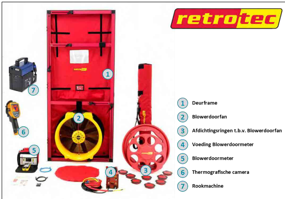
Figuur 2: Meetapparatuur Blowerdoortest
