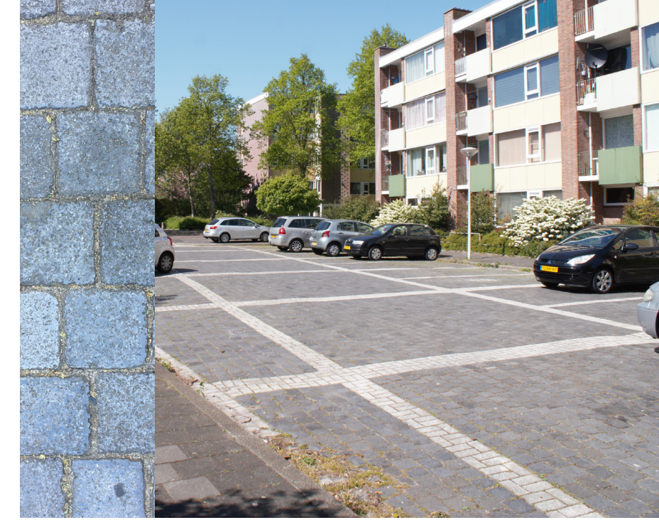
KOPERSLAKKEIEN (HERGEBUIK) 16x16cm, kleur zwart, hergebruik uit hofjes fase 1
