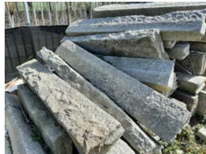
Natuurstenen banden van de steenwisselplaats. De lengtes variëren van 1,50 tot 2,00m
